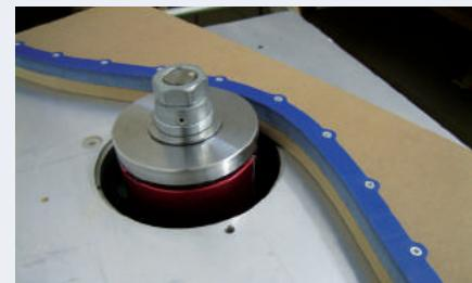
**(DE)** Einfach auf der Tischfräse am „KURVENLINFIX“ entlang fräsen.
