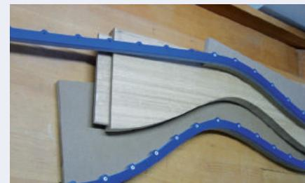
**(DE)** „KURVENLINFIX“ abschrauben, das Werkstückmodell ist fertig.
