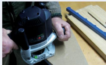
**(DE)** Einfach mit der Oberfräse am „KURVENLINFIX“ entlang fräsen.
